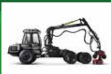
Malwa 560C: Vægt: 6 tons - Bredde: 2,15 m. - Længde: 6 m.
